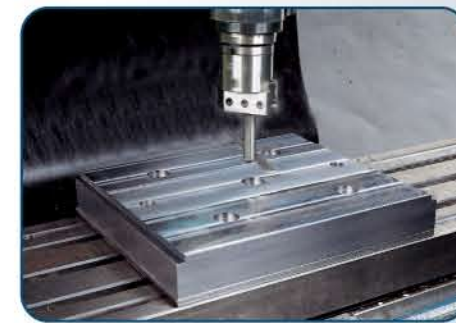
工件中心鏜孔測試 150mm x 150mm等距離公差於±0.01mm。
