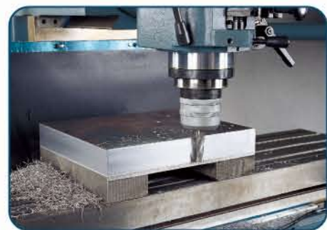
銑邊細加工測試 工件300x260mm 精加工後於標準公差內。
