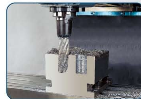
方形工件銑邊重切削測試 五刃粗銑刀Ø40x70高速鋼，工件材料S50C中碳鋼，全刀深銑削，無振動。
