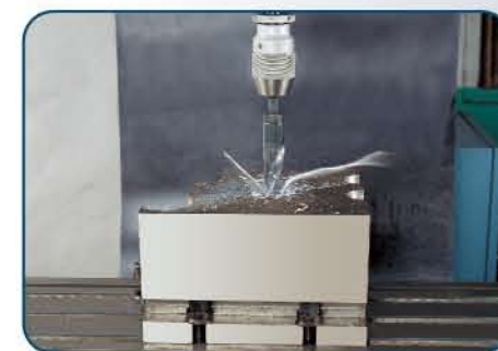
鑽孔重加工測試 Ø26鑽頭自動進刀一次完成。
