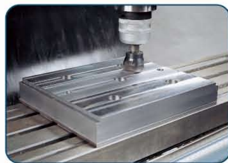
平面銑削加工測試 工件300x260mm三刃Ø50平面銑刀，精加工後，平面段差於標準公差內。
